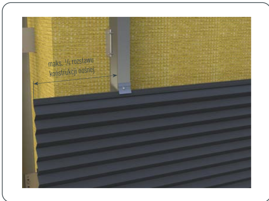
Ilustracja 3 • Maks. występ profili wyłaczanych
