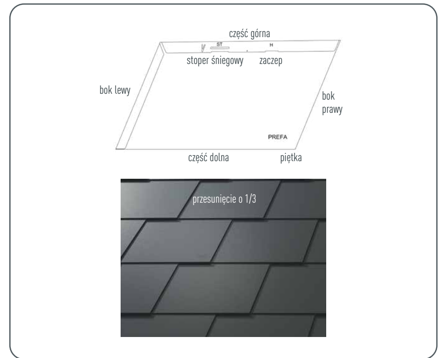
Rysunek 25 • Dachówka łupkowa – kierunek krycia i mocowanie
