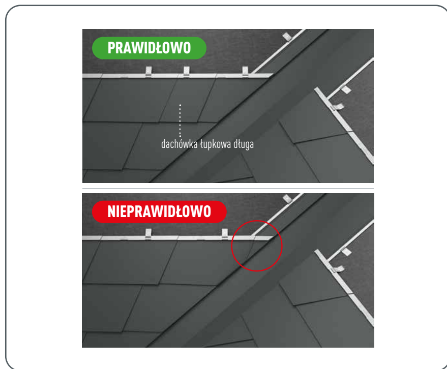
Rysunek 62 • Formowanie kosza dachowego – dodatkowe wytyczne dotyczące dachówki łupkowej
