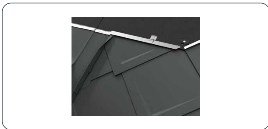
Rysunek 112 · Wyłaz dachowy – dodatkowe wytyczne dotyczące dachówki romb 29 \times 29 i 44 \times 44
