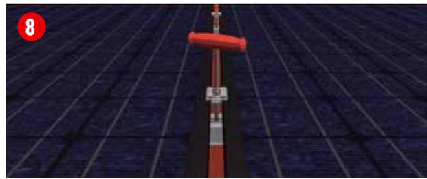
**1** Oberteil des PREFA Solarhalter Vario locker angezogen, mittig auf die Gewindestange setzen
