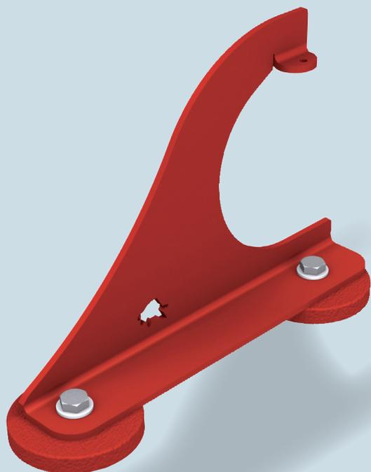
Die Montage erfolgt mit zwei Fußteilen auf der Dachhaut. In die Gebirgsschneefangstützen können Rundhölzer bis  $\varnothing$  140 mm eingelegt und mittels der mitgelieferten Schrauben fixiert werden. Gesamthöhe der Stützen mit Fußteilen: 219 mm. Die Gebirgsschneefangstützen können auch nachträglich montiert werden. Verfügbar in allen Farben für PREFA Dachsysteme (Kleinformat).
